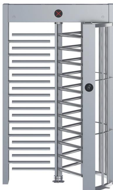
Полноростовой однопроходной турникет СПЕКТР обладает пылевлагозащитными свойствами (IP 54) и устойчив к внешнему воздействию климатических факторов. Благодаря высокой степени защиты, модель можно использовать внутри помещения или снаружи (под навесом) в любую погоду.
